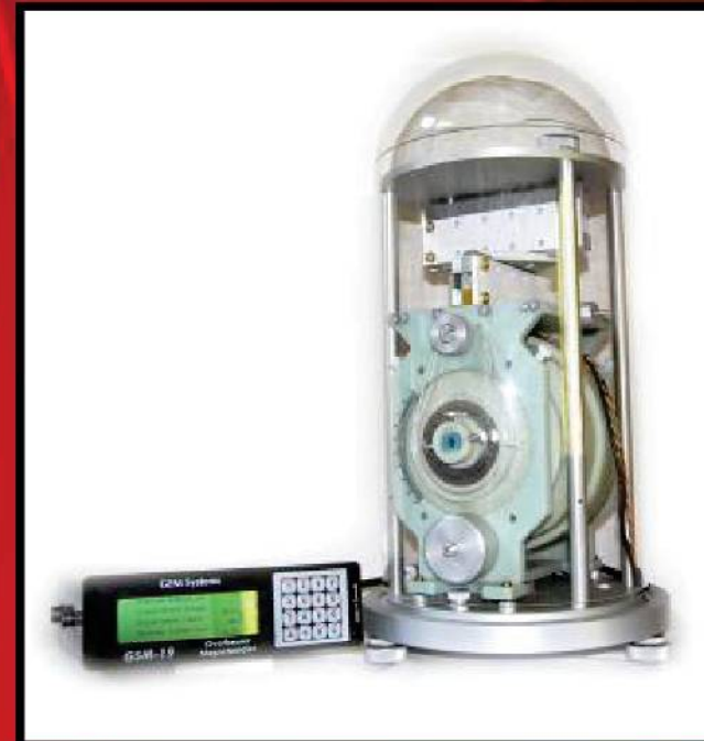
吊り下げ式 偏角・伏角変化計 (オーバーハウザー磁力計)
